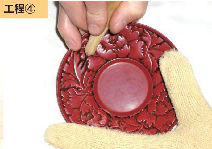
「毛彫り」艶消しをした後、毛彫りを施し、漆を摺り込む。
