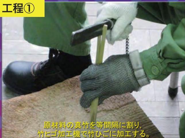
原材料の真竹を等間隔に割り、竹ヒゴ加工機で竹ひごに加工する。
