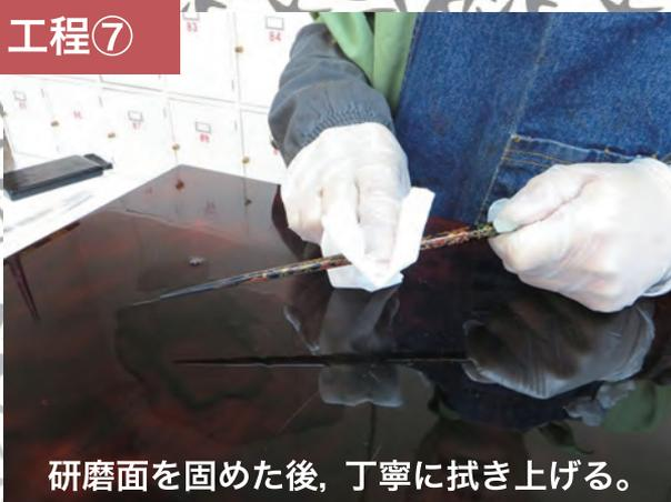
研磨面を固めた後、丁寧に拭き上げる。
