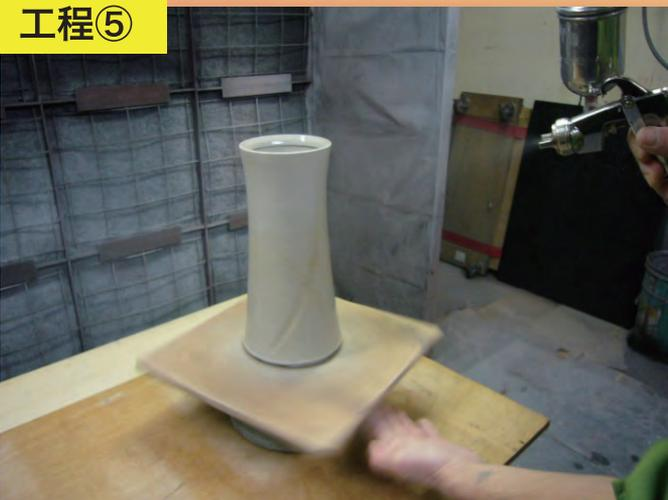
素焼後、花器を回転させながら、スプレーガンで釉薬を吹き付ける。
